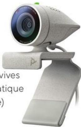
Concentrez-vous sur votre voix et non sur le bruit de fond grâce à un système orientable à multiples microphones qui permet la réduction du bruit et de l'écho.
